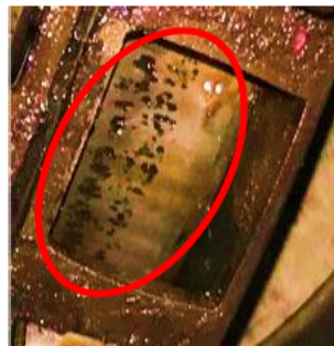
内輪転動面に フレーキング有
